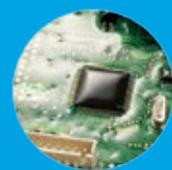
Superfície da placa eletrônica de controle utiliza tecnologia de encapsulamento SMT
