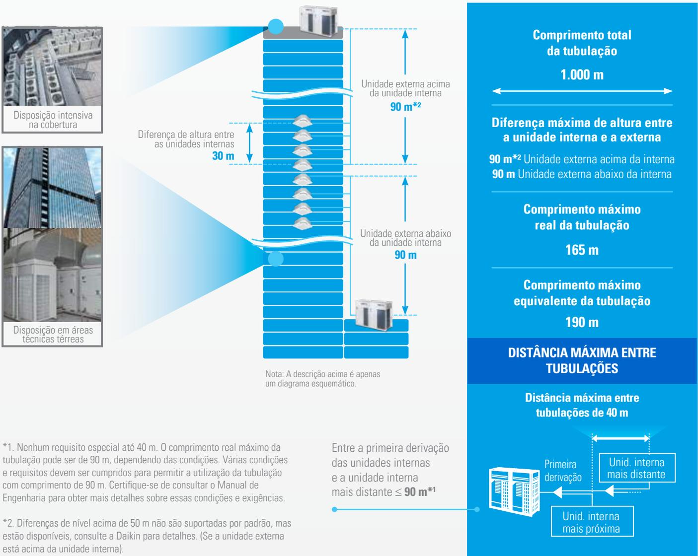
\*1. Nenhum requisito especial até 40 m. O comprimento real máximo da tubulação pode ser de 90 m, dependendo das condições. Várias condições e requisitos devem ser cumpridos para permitir a utilização da tubulação com comprimento de 90 m. Certifique-se de consultar o Manual de Engenharia para obter mais detalhes sobre essas condições e exigências.
