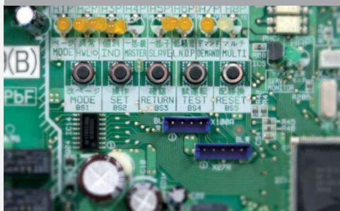
Decifra a informação de operação do sistema pela leitura do estado dos LEDs, que é ineficiente e sujeito a falhas.
