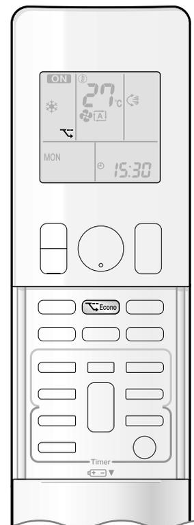
A operação ECONO é uma função que permite um funcionamento eficaz por limitar o valor máximo do consumo de energia.
