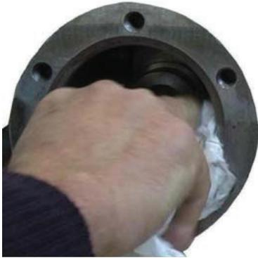
Remova o filtro e limpe o compartimento. Limpe todos os outros componentes. Substitua os anéis de vedação.
