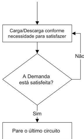
O(s) circuito(s) que permanecer(em) em operação será carregado(s)/descarregado(s) conforme necessário, para atender à demanda (carga térmica).
