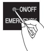
Use um objeto pontiagudo para pressionar o comutador de operação de emergência.
