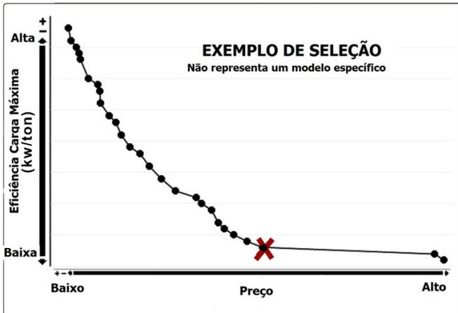
A seleção de unidade ótima vai variar com a obra e o projeto. As aplicações com poucas horas de operação não podem justificar uma unidade com um kW por tonelada (COP) muito baixo. As aplicações com muitas horas da operação irá justificar alta carga parcial assim como unidades com carga máxima. Para uma seleção ideal uma análise energética pode ser obtida com seu representante Daikin.
