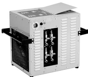
Compressor de comando aberto de 1 ½-HP, linhas de ½-pol, extração de vapor de dois pontos e recuperador de condensador refrigerado a ar em chillers menores. A recuperação da purga e a mudança de líquido em vapor somente envolve uma válvula de 3 vias - não há necessidade
